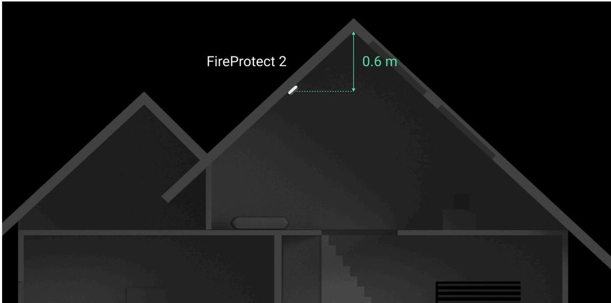
Wir empfehlen nicht, den Melder an eine Wand zu montieren. Diese Art der Installation ist zulässig, wenn eng beieinander liegende Balken oder andere Hindernisse die Installation des Melders stören. Eine Wandbefestigung ist nur möglich, wenn der Melder in einem Abstand von 15–30 cm unter der Decke, aber höher als die Türen platziert wird.
